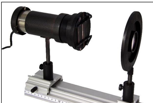
5-rasm. Difragma tutgichi va kondenser o'rnatilgan lampa.
