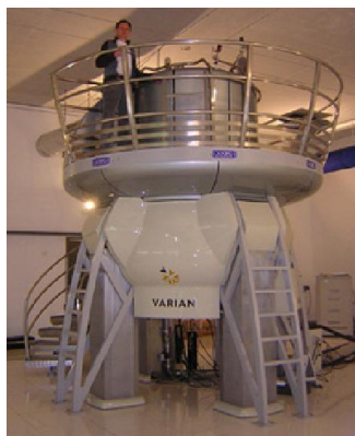
Birmingem shahridagi 900 MGts chastotada ishlaydigan YaMR qurilmasi
