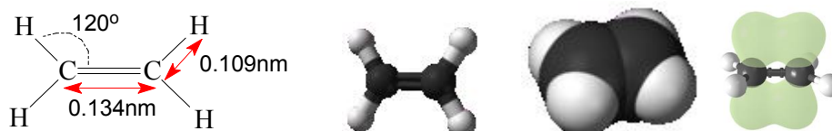
Etilenning tuzilishi va modellari
