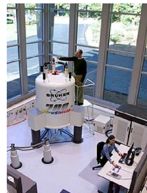
Bruker 700 MGts YaMR spektrometri
