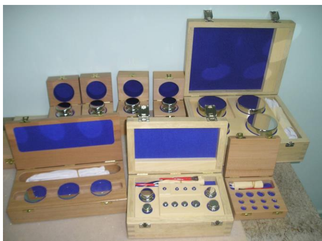
3-rasm – Massa birligi boshlang’ich milliy etaloni qadoqtoshlari
