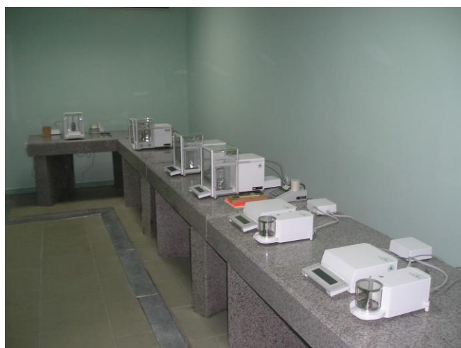
4-rasm – Massa birligi milliy boshlang’ich etalonining tarozilari
