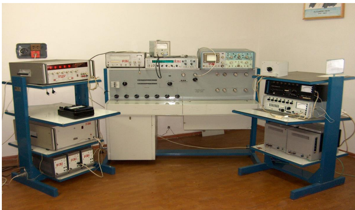
7 – rasm. O‘zgaruvchan tok kuchlanishi birligi milliy boshlangich etaloni
