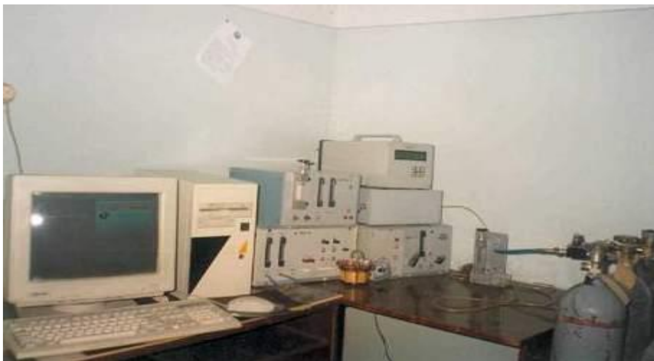
5-rasm. Ammiak, sinil kislota, azot dioksidi, havodagi oltingugurt dioksidi va xlorning (SO, Cl 2 , HCN, SO 2 , NO 2 va NH 3 ) massa ulushi birligi milliy etaloni.
