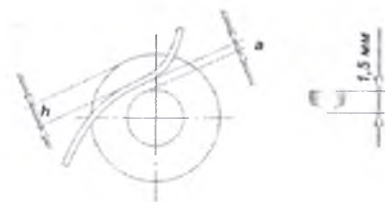
10.5-rasm. Arra bilan qobirg'a orasidagi o'lchamlar.
