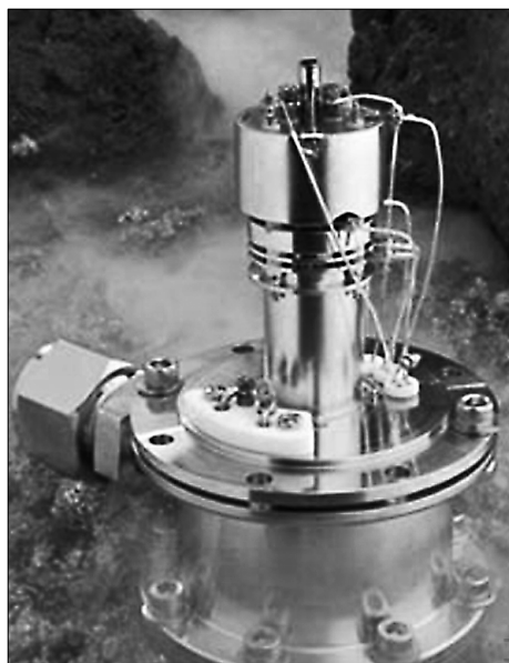
Рис. 17.12. Миниатюрный квадрупольный масс-спектрометр (размеры 5 \times 5 \times 5 см; масса 2 кг)
