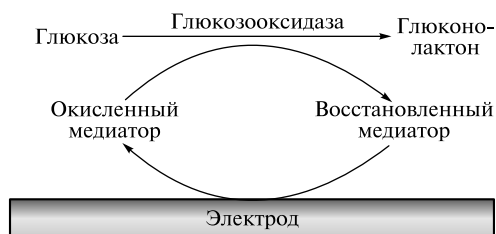
Рис. 15.7. Схема биосенсора второго поколения
