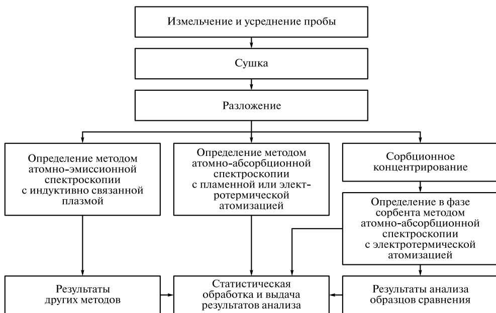
Рис. 19.1. Схема анализа минерального сырья, построенная по блочно-модульному принципу
