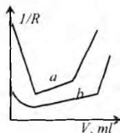
24.8-chizma. Ikki negizli kislotalarni ishqor eritmasi bilan titrlash: a -xromat kislota; b -malein kislota
