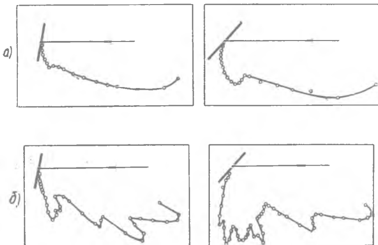
207- расм. а) қиздиришгача; б) қиздиришдан сўнг поликристалл никель пластинканинг электронларни сочиши.
