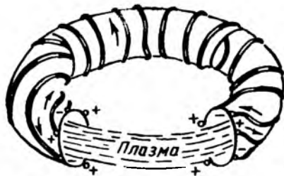
7. 14- расм. Плазмани тор ёки стелларатор типидagi қурилма.
