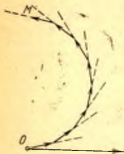
8.7- расм. Зонанинг алоҳида қисмлари таъсирини қўшувчи векторли диаграмма.
