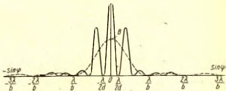
9.11-расм. Бир-биридан d масофани жўлашган ва кенглиги b бўлган икки параллел тирқишдан ҳосил бўлган дифракцияда интенсивлик тақсимоти.
