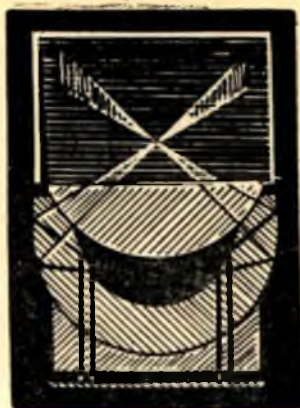
15.9- расм. Қоронғи майдон методини амалга оширадиган махсус конденсорнинг кесими.
