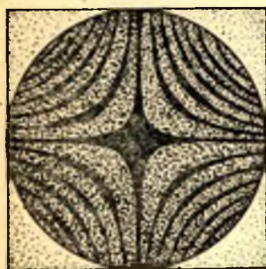
26.26- расм. Бир ўқли кристалнинг оптик ўққа параллел қилиб кесиб олинган пластинкаси учун изохроматалар шакли.
