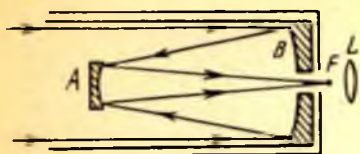
14. 18-расм. Кассегрен рефлекторининг схемаси.
