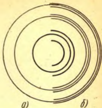
40.13-расм. Фабри—Перо эталонини гелий-неонли лазер нурланиши ( \lambda = 632,8 нм) билан ёритиб олинган интерференцион ҳалқалар.
