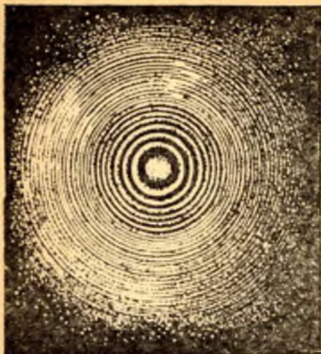
7.5- расм. Фабри — Перо эталонида кўринадиган интерференцион манзара (тенг оғмалик чизиклари).
