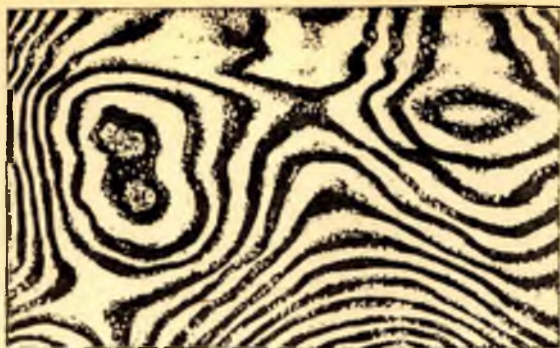
6.2- расм. Қалинлиги ҳамма жойда бир хил бўлмаган шиша пластинканинг икки сиртидан қайтган ёруғликда олинган интерференцион манзара.
