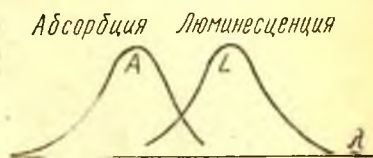
39.3- расм. Стокс қондасини тушунтирувчи схема.
