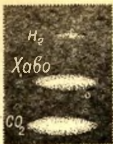
29.4- расм. Водород, ҳаво ва карбонат ангидрида молекуляр сочилиш интенсивликларини солиштириш.
