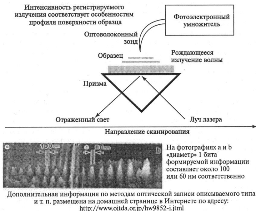
Рис.10. Принцип работы сканирующего оптического микроскопа ближнего поля
