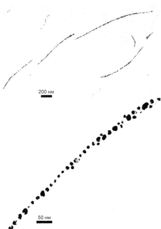
Рис.43. Изображение одномерного множества наночастиц золота, образованных при взаимодействии с полиэтиленоксидом и полиполисахаридами, в просвечивающем электронном микроскопе
