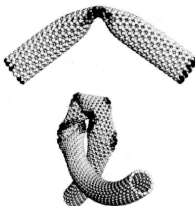
Рис.50. Моды деформации одностенных нанотрубок, обуславливающие высокую упругость. Такое поведение, вероятно, является следствием гибкости графитовых слоев и легкости регибридизации атомов углерода из состояния sp^2 в состояние sp^3
