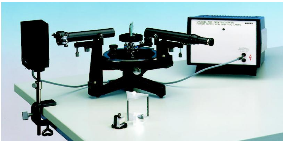
1-rasm. Suyuqliklarda dispersiya aniqlash tajriba ishini kuzatish qurulmasining yig'lgan holati
