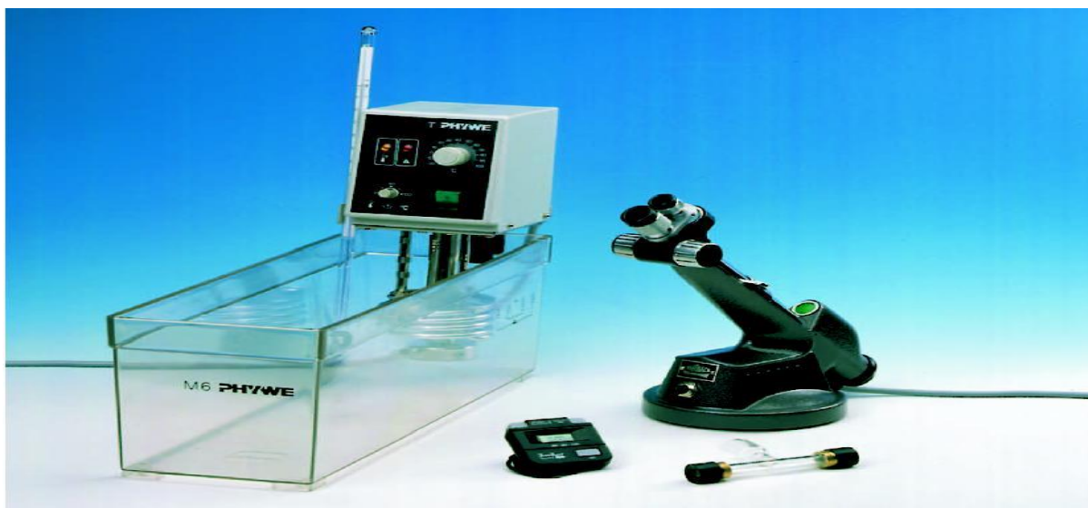
2-rasm. Shakar eritmalarida qutblanish tekisligining aylanishini aniqlaydigan eksperimental qurilmasi.
