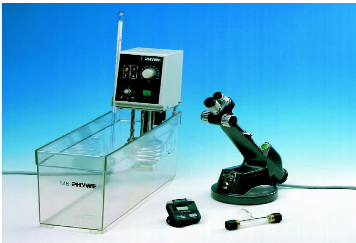
2-rasm. Shakar eritmalarida qutblanish tekisligining aylanishini aniqlaydigan eksperimental qurilmasi.
