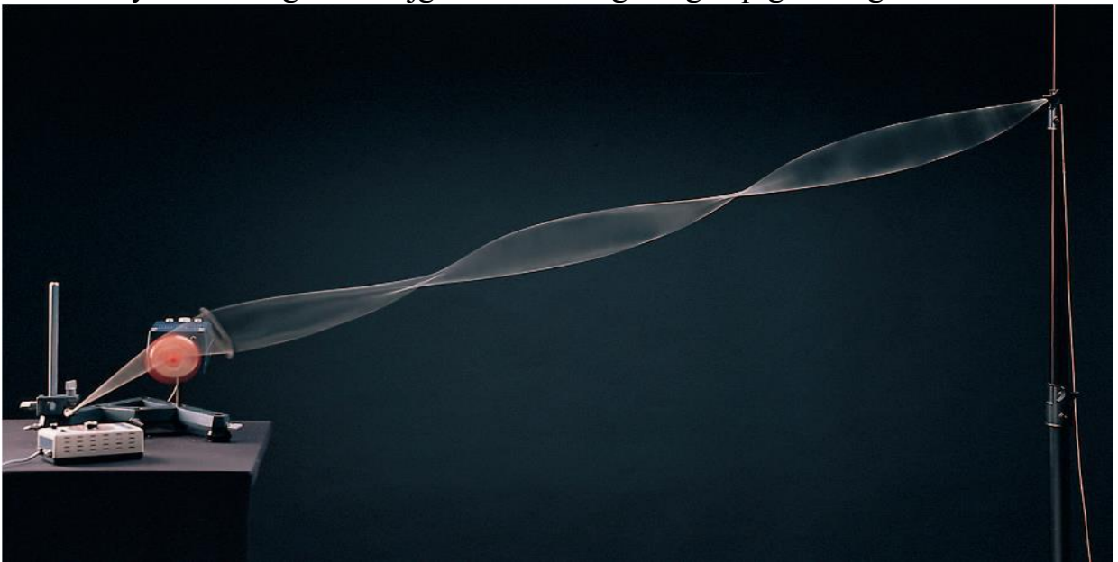
1-rasm: Jgut (rezina) dagi to'lqinlarni o'rganuvchi tajriba qurilmasi:
