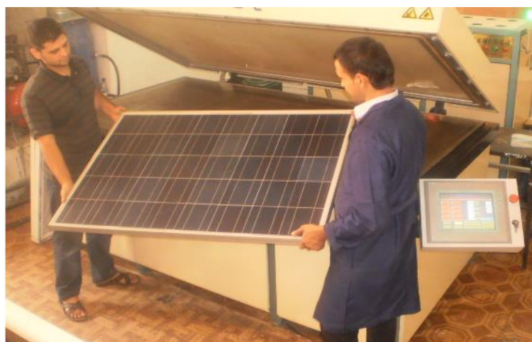
42-rasm. Fotoelektrik modul laminatsiya pechidan so'ng
