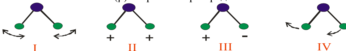
12-Расм. Метилен гуруҳининг деформацион тебранишлари: I-қайчисимон (1467 \text{см}^{-1} ), II-урчуксимон айланма ( \sim 1300 \text{ см}^{-1} ), III-айланма ( \sim 1300 \text{ см}^{-1} ) ва IV-маятниксимон (790-720 \text{см}^{-1} ).
