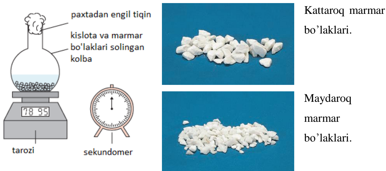
5.11 rasm. Reaksiya tezligiga qattiq modda yuzasining ta'sirini o'rganuvchi tajriba 52 .
