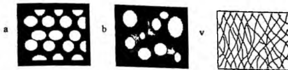
15.5-rasm. Emulsiya turlari: konsentrlangan monodispers emulsiya (a), polidispers emulsiya (b), yuqori konsentrlangan emulsiya (v)
