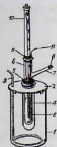
Erigan moddaning molekulyar massasini aniqlash uchun asbob (krioskop)
