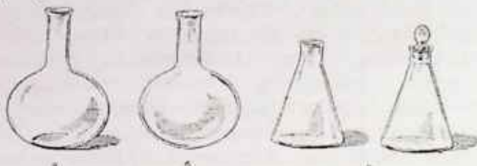
3- rasm. Kolbalar: a – tagi yassi; b – tagi dumaloq; v – konussimon.
