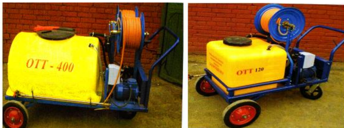
44-расм. Белоруссияда ишлаб чиқарилган ОТТ-400 ва ОТТ-120 ғалтакаравали иссиқхона пуркагичи
