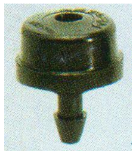
PCI. Босимни компенсациялаш- гириб кўпиклаб чиқарувчи «дятел» типдаги томчилатувчи мослама. Сув сарфи: 2, 3, 4, 8 л/с
