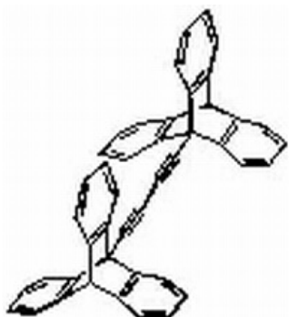
Рис. 12.12. Структуры молекулярных машин на основе производных а — триптицена и б — фуллерена
