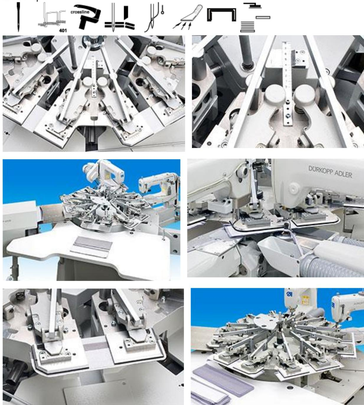
Рисунок 39. Рабочие станции швейного автомата 971-01 «Durkopp Adler».
