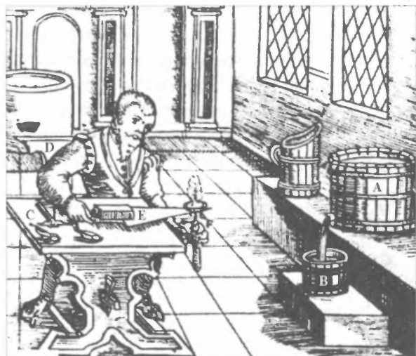
Лаборатория для определения качества селитры (из книги Л. Эркера «Описание всех известных минеральных руд»). А – выщелачивание «селитряной земли», ... С – весы, ... F – выпаривание пробы с помощью свечи
