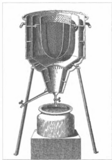
Ледяной калориметр (разрез), используемый А. Л. Лавуазье и П. С. Лапласом
