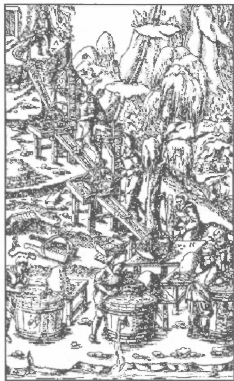
Система для обогащения руды (из книги Георга Бауэра (Агриколы) «О горном деле и металлургии»)
