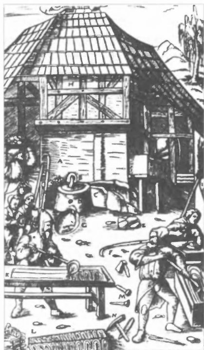
Выплавка и «высадка» олова (из книги Л. Эркера «Описание всех известных минеральных руд»)
