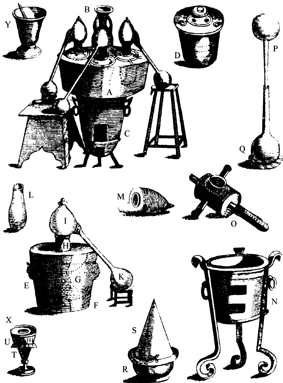
Оборудование химических лабораторий XVII–XVIII вв. Из. Книги Н. Лемери «Курс химии» (Париж, 1756): А, D – медные водяные бани для перегонки алембиков; В – воронка; С – железная печь; H – перегонная колба на песчаной бане; I, M – шлемы; К – приемник; L – перегонная колба; P, Q – соединенные сосуды; X – керамическая чашка; Y – ступка
