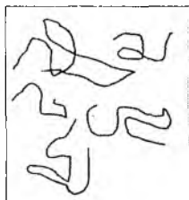
68-rasm. Makromolekulalarning suyultirilgan (a) va konsentrlangan (b) eritmalarida o'zaro joylashish sxemasi.
