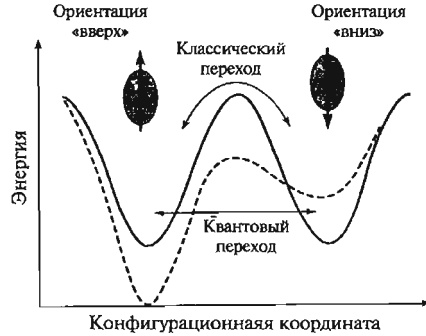
Рис. 7.8. Схема потенциала двойной ямы, на которой показана зависимость энергии от ориентации магнитного момента в отсутствие (сплошная линия) и при наличии (прерывистая линия) внешнего магнитного поля.
