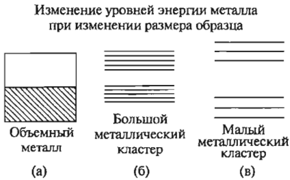
Рис. 4.9. Пример изменения уровней энергии металла при уменьшении количества атомов: (а) – валентная зона объемного металла; (б) – в большом кластере из 100 атомов возникает запрещенная зона; (в) – маленький кластер, состоящий из трех атомов.
