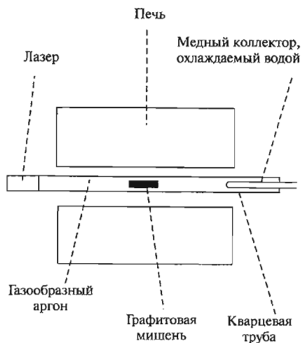
Рис. 5.12. Экспериментальная установка для синтеза углеродных нанотрубок лазерным испарением.
