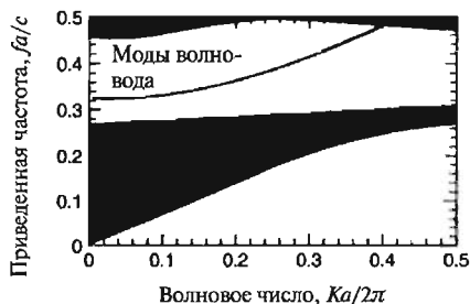
Рис. 6.32. Влияние удаления одного ряда стержней из квадратной решетки кристалла, которое приводит к появлению уровня в запрещенной зоне со свойствами волновода. По оси ординат отложена частота f , умноженная на параметр решетки a и деленная на скорость света c .
