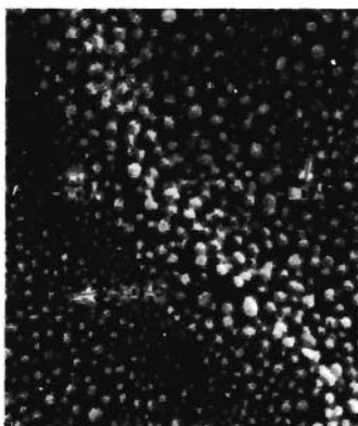
Рис. 3.17. Микроснимок частиц золота диаметром 3 нм ( 30 \text{ \AA} ) на углеродной подложке, полученный на сканирующем электронном микроскопе.
