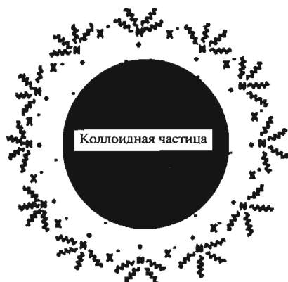
Рис. 10.22. Металлическая коллоидная частица, стабилизированная молекулами галлида тетраалкиламмония \text{NR}_4\text{X} .
