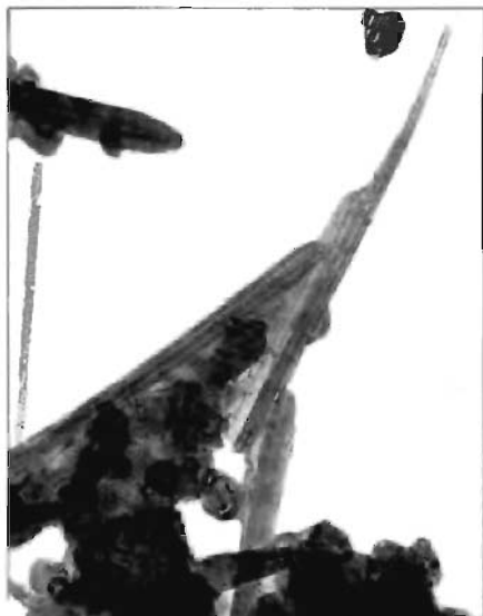
Рис 2. Микрофотография явления агломерации астраленов на многослойных нанотрубках.
