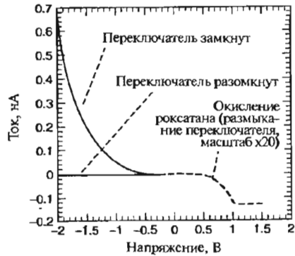
Рис. 13.22. Вольтамперные характеристики молекулярного переключателя, изображенного на рис. 13.21.
