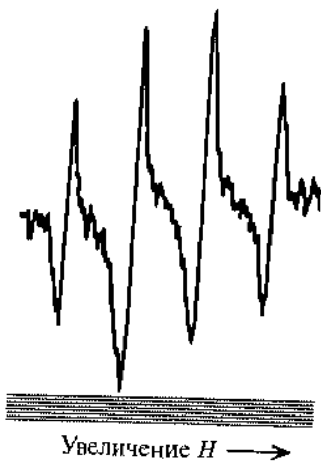
Рис. 2.54. Спектр ЭПР метильного радикала (с применением производной) при 4,2 К
