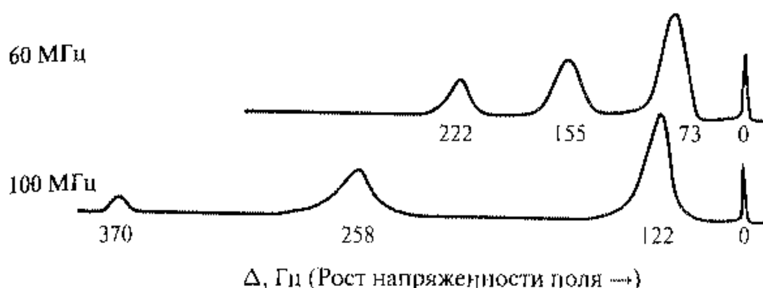
Рис. 2.53. Спектр ЯМР \text{CH}_3\text{CH}_2\text{OH} при 60 МГц и 100 МГц
