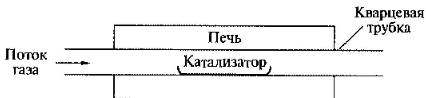
Рис. 1.21. Схема получения с УНТ с помощью катализаторов
