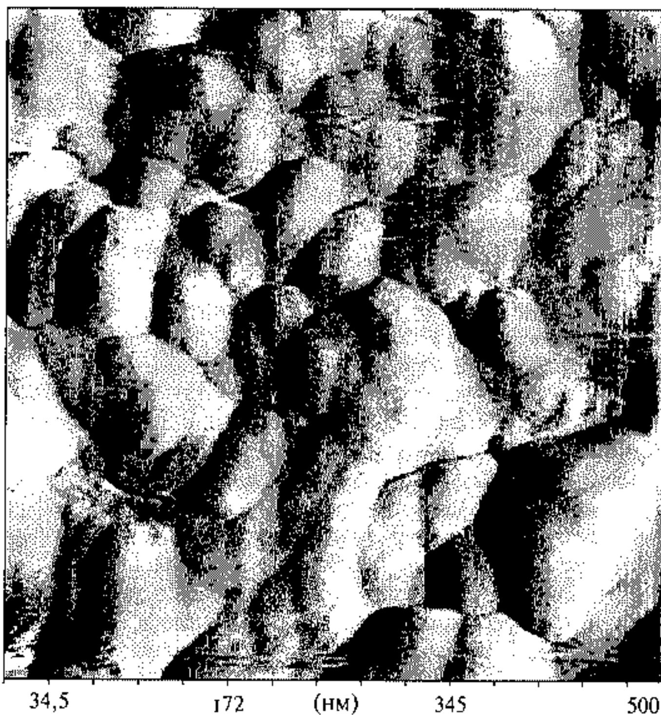
Рис. 16.29. Изображения с помощью атомно-силового микроскопа наноструктуры \alpha - и \gamma -оксидов железа. Масштаб изображения по горизонтали и вертикали — 500 нм [27]
