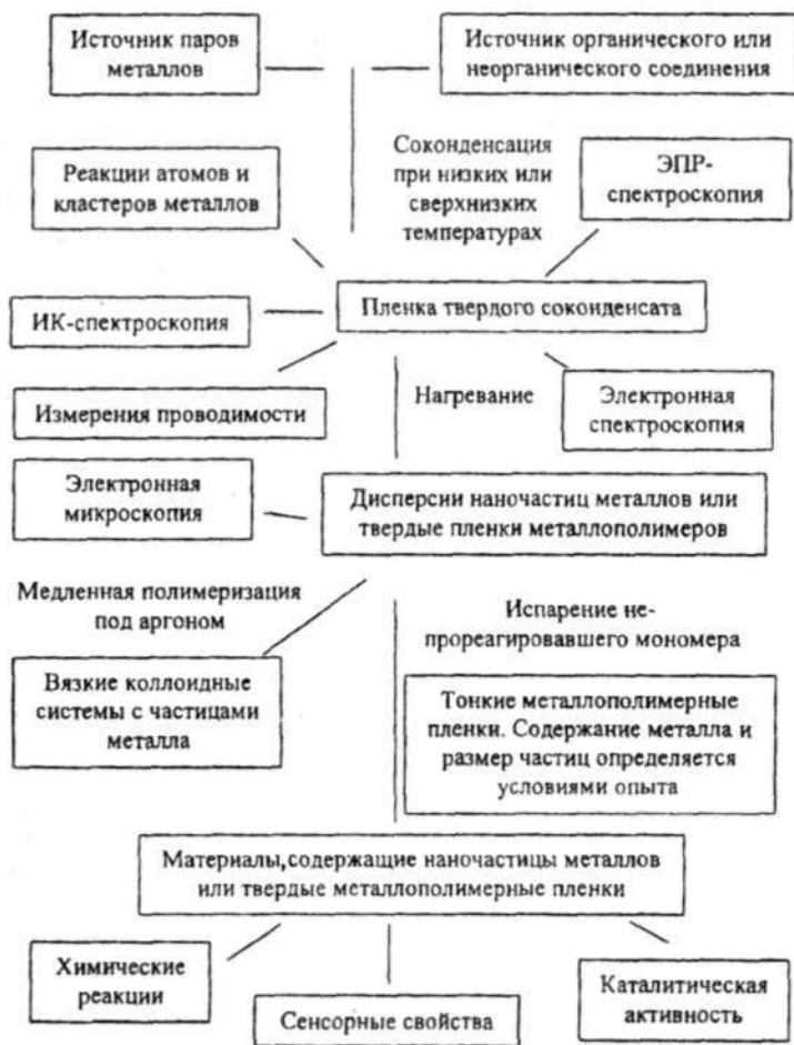
Рис. 24. Криохимический синтез наноразмерных материалов, включенных в органические и полимерные матрицы
