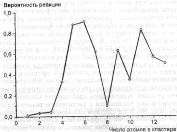
Рис. 37. Влияние размера частиц ниобия \text{Nb}_x на реакции с бензолом [291]
