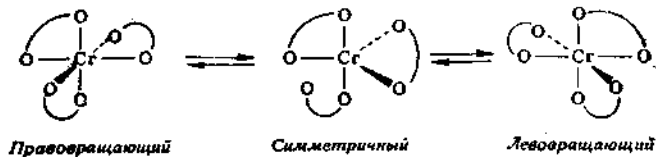
Рис. 36. Механизм рацемизации [\text{Cr}(\text{C}_2\text{O}_4)_3]^{3-} .
