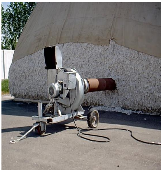
16-расм. УВП русумли кўчма вентиляторнинг ғарамга ўрнатилиши ва қурилманинг тузилиши.
