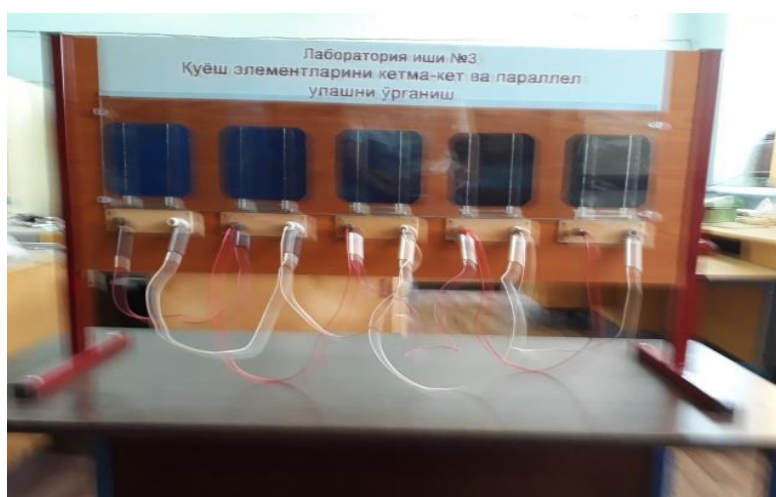
3-rasm. Quyosh elementlarini parallel ulash uchun tajriba stendi
