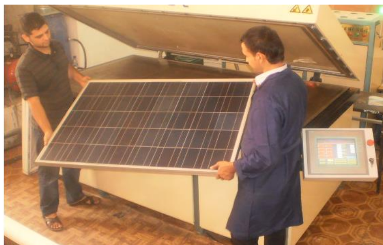
31-расм. Фотоэлектрик модул ламинация печидан сўнг
