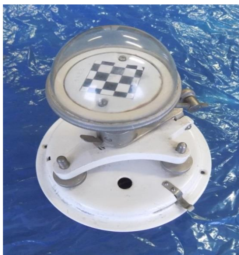
14-расм. Универсал пиранометр М-80.
