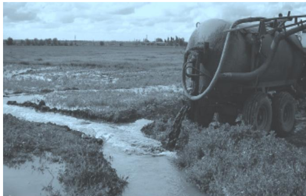
7.5-расм. Биошламни АНЖ туридаги автомашиналарда ташиб келтириб ариқлардан юбориш усули.
