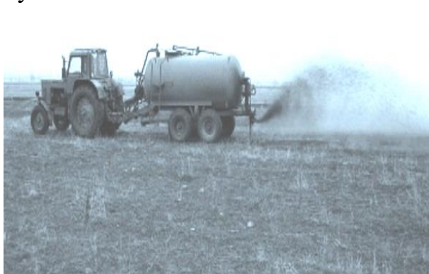
7.4-расм. Биошламни РЖ туридаги машиналарда шудгордан олдин сачратиб сепиш усули.
