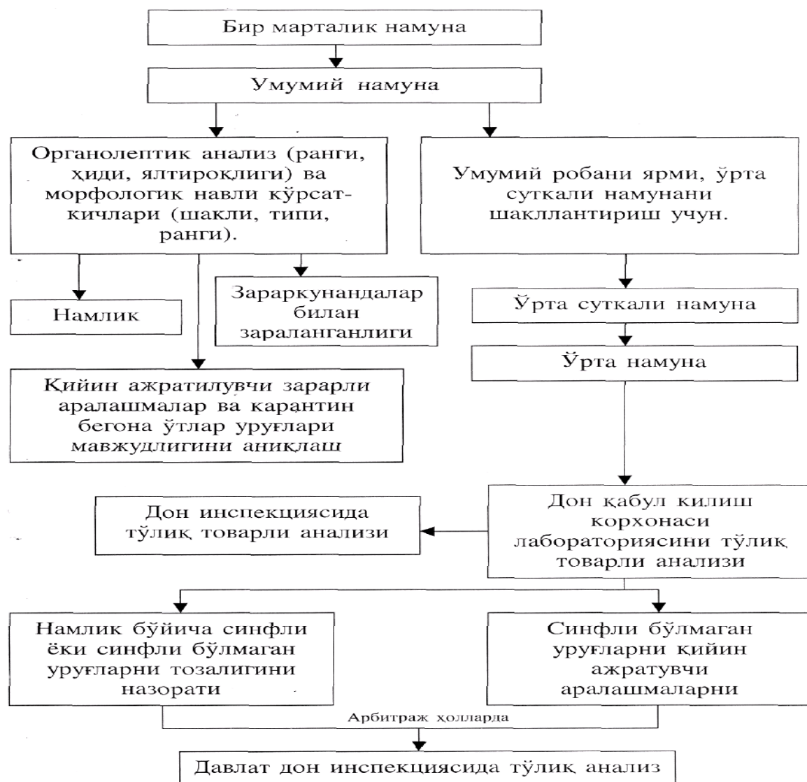
3.2-rasm. Don qabul qilish korxonasi ga kelgan urug' larni laboratoriya analiz qilish tizmasi.
