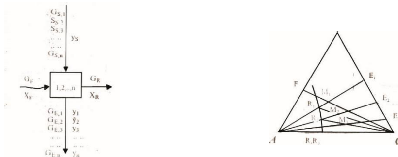
8.6-rasm. Erituvchini vaqti-vaqtida almashtirish usulida qattiq jismdan ekstraksiya qilish.
