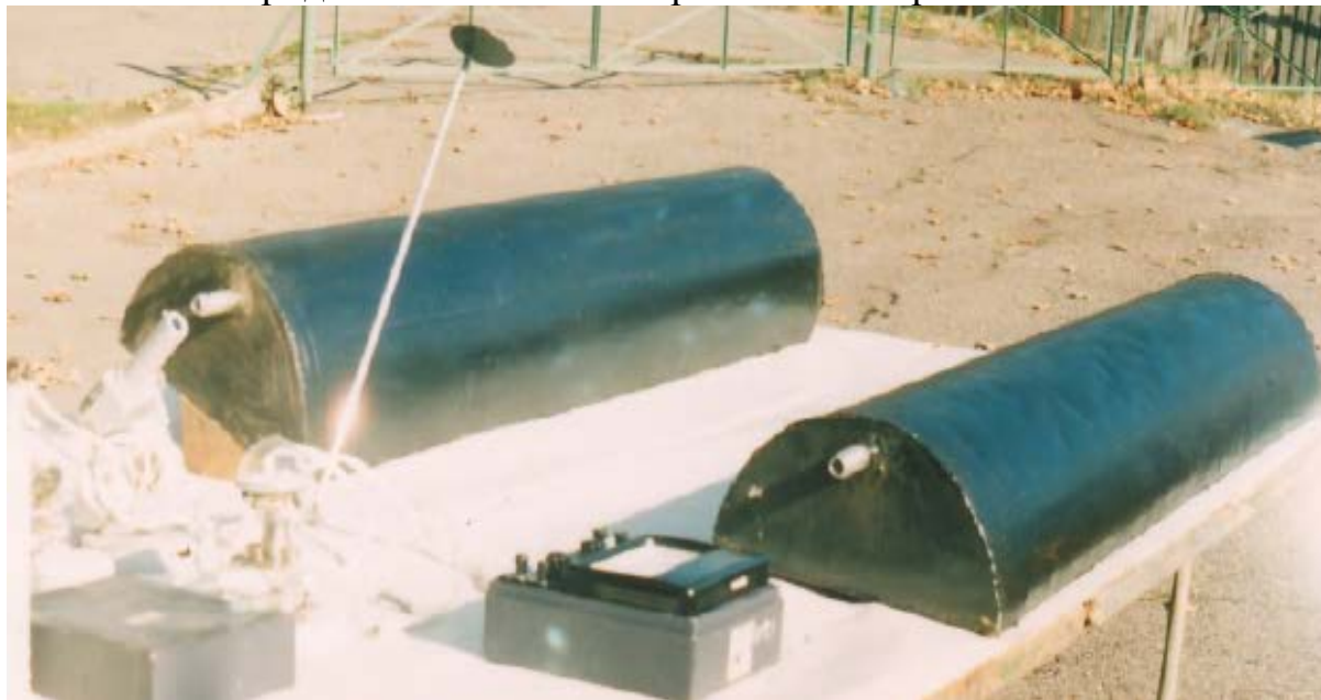
Рис.1.5. Общий вид абсорбционного солнечного водонагревательного коллектора с емкими теплоприемниками полуцилиндрической формы.
