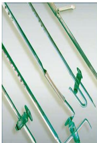
1.11 –rasm. Xajmiy analizda qoʻllaniladigan byuretkalar
