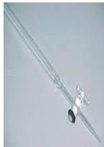
1.11 –rasm. Xajmiy analizda qoʻllaniladigan byuretkalar
