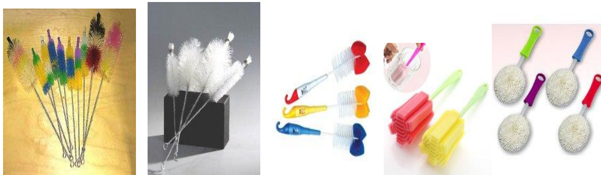
7-rasm. Idishlarni yuvish uchun yorshlar: probirkalar kolba, stakan va hovonchalar uchun;
