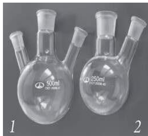
16-rasm. Туби юмалоқ колбалар: 1-уч оғизли; 2- - икки оғизли.
