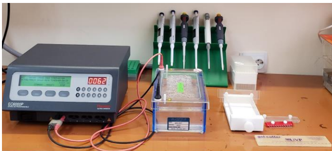
3 - rasm. Agarozada gelida gorizontaal elektroforez o'tqazish uskunasi elementlari: Elektr tok manbai, gel quyish uchun lotok, gel ushlagich, taroqlar va lineyka.
