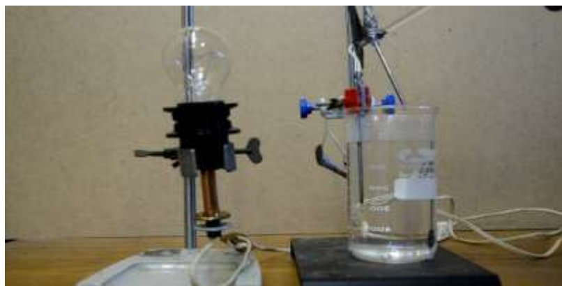
8.1-rasm. Eritmalarning elektr o‘tkazuvchanligini aniqlash asbobi.
