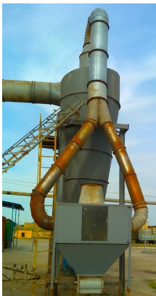
3.14-расмда келтирилган қурилмани икки ён томонидан симметрик равишда бир хил геометрик ўлчамларга тенг бўлган кувурлар ажратиш
