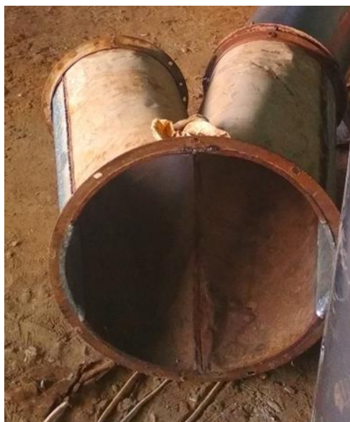
3.12-расм. Ҳаво оқимини иккига бўлувчи мосламанинг кўриниши.
