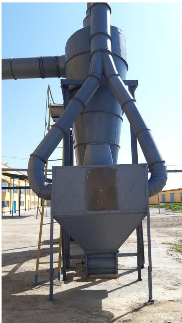
3.15-расм. “Зарбдор пахта тозалаш” АЖда яратилган интенсив усулда тазолаш қурилмасини умумий кўриниши.
