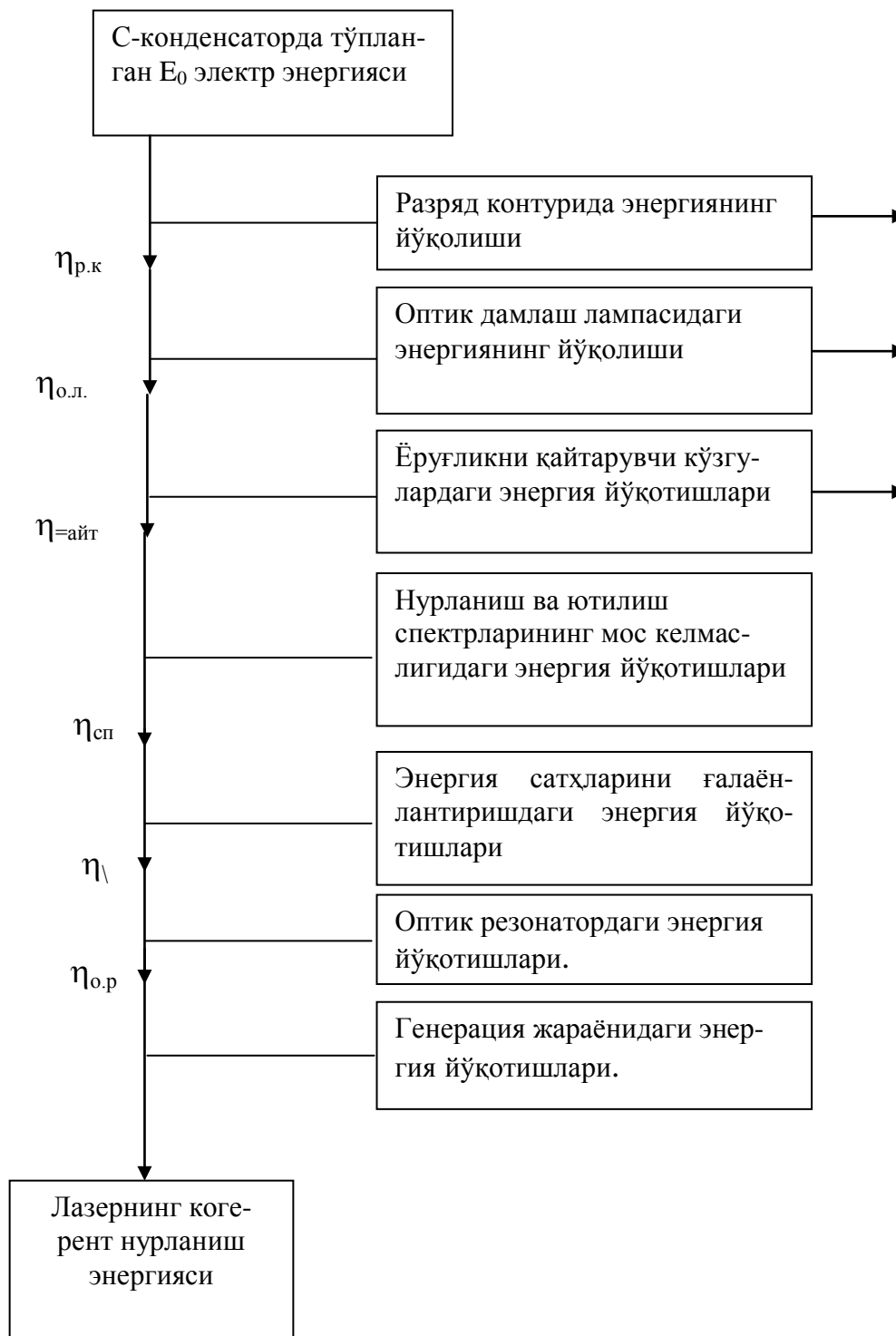
31-расм. Лазер курилмасининг ишлашида электр энергиясининг когерент лазер нурланиш энергиясига айланишдаги энергия йўқотишларининг турлари
