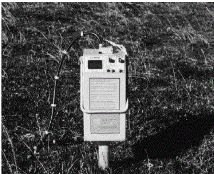
50-rasm. Neytron tekshirish uskunasi kirish trubasinida. Qora kabelda tezkor neytronlar manbasini pastga uzaytiradi.
