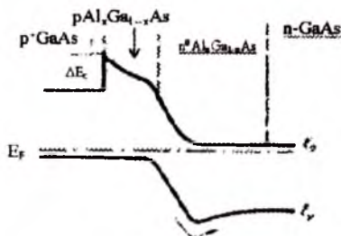
VIII.1 расм.Силлиқ гетероўтиш асосида юқори вольтли диод
