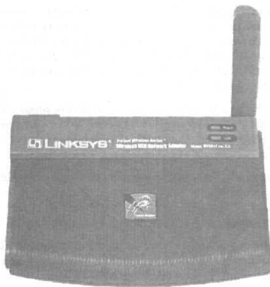
Рис. 14.1. После подключения этого сетевого адаптера компании Linksys к порту USB ваш компьютер становится одним из узлов беспроводной сети Wi-Fi
