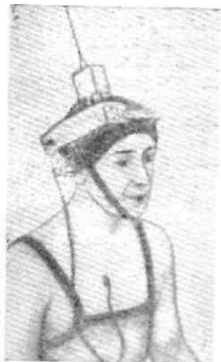
16-расм. Электрокардиограммани ёзиб олувчи радиопередатчик. (одам бошидаги шлёмга ўрнатилган)
