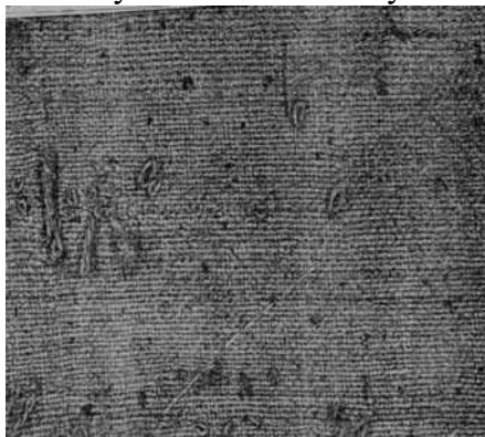
3.39- rasm. Arqoqni xalqalanishi nuqsoni.
