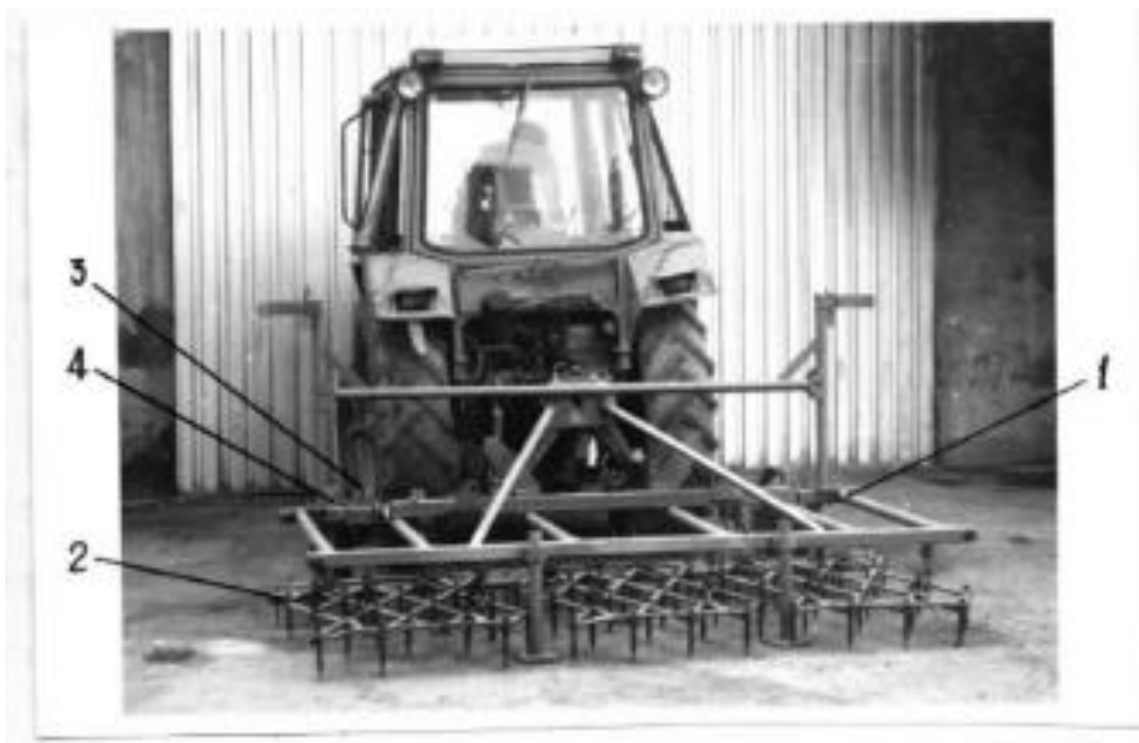
Рис.4.8. Установка для исследований параметров рыхлителя. 1-брус навесной сцепки; 2-рыхлитель; 3-регулирующий винт; 4-опорное колесо.
