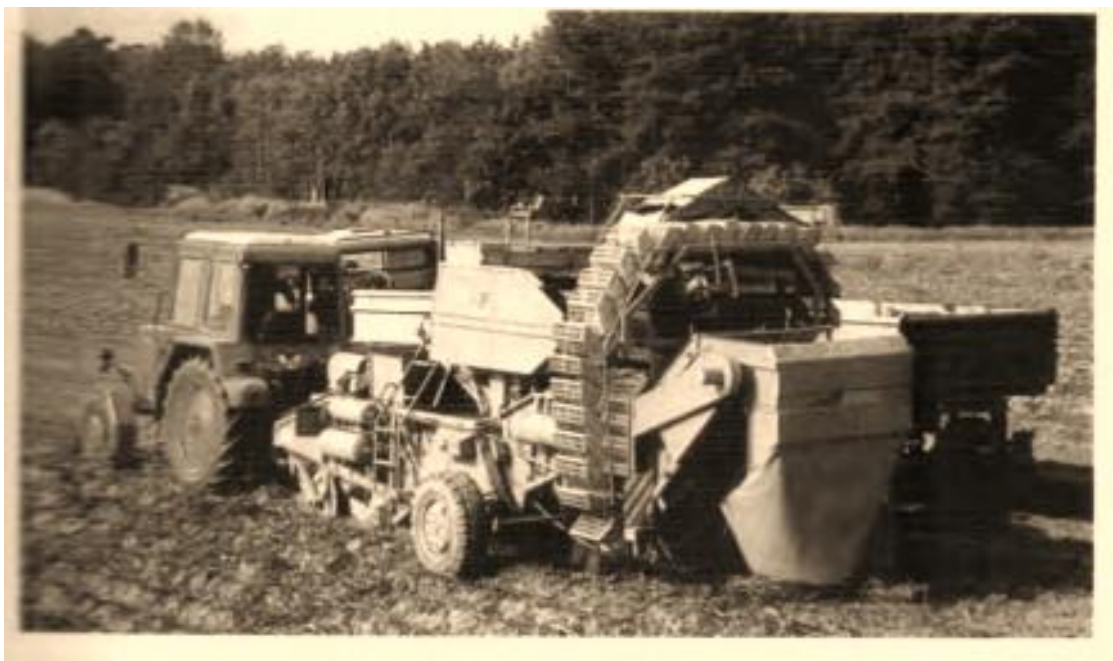
1.45-rasm. Takomillashgan tirkama kombaynning ish jarayoni
