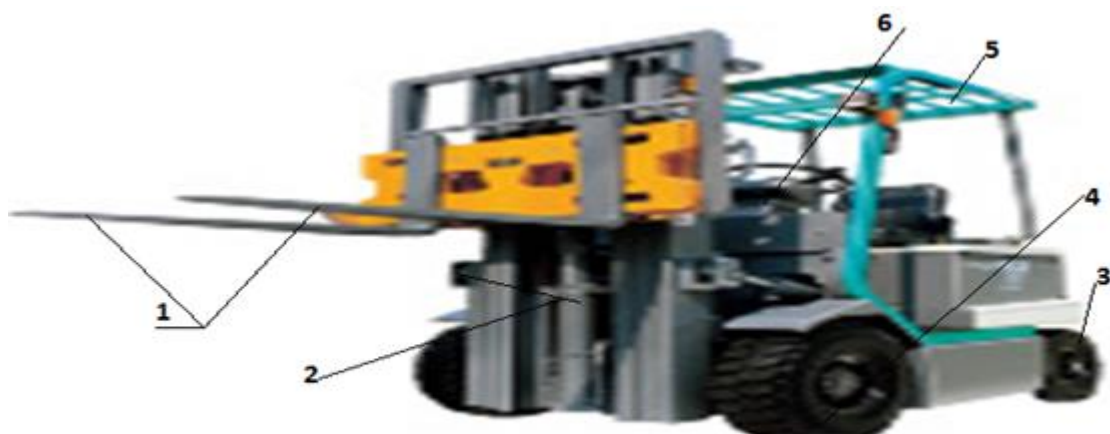
1-юк кўтарадиган бармоқлар; 2-юкни вертикал текисликда ҳаракатга келтирадиган механизм; 3,4-машиналарни ғилдираклари; 5-операторни ҳимоялаш қурилмаси; 6-операторни нг бошқарув жойи.
