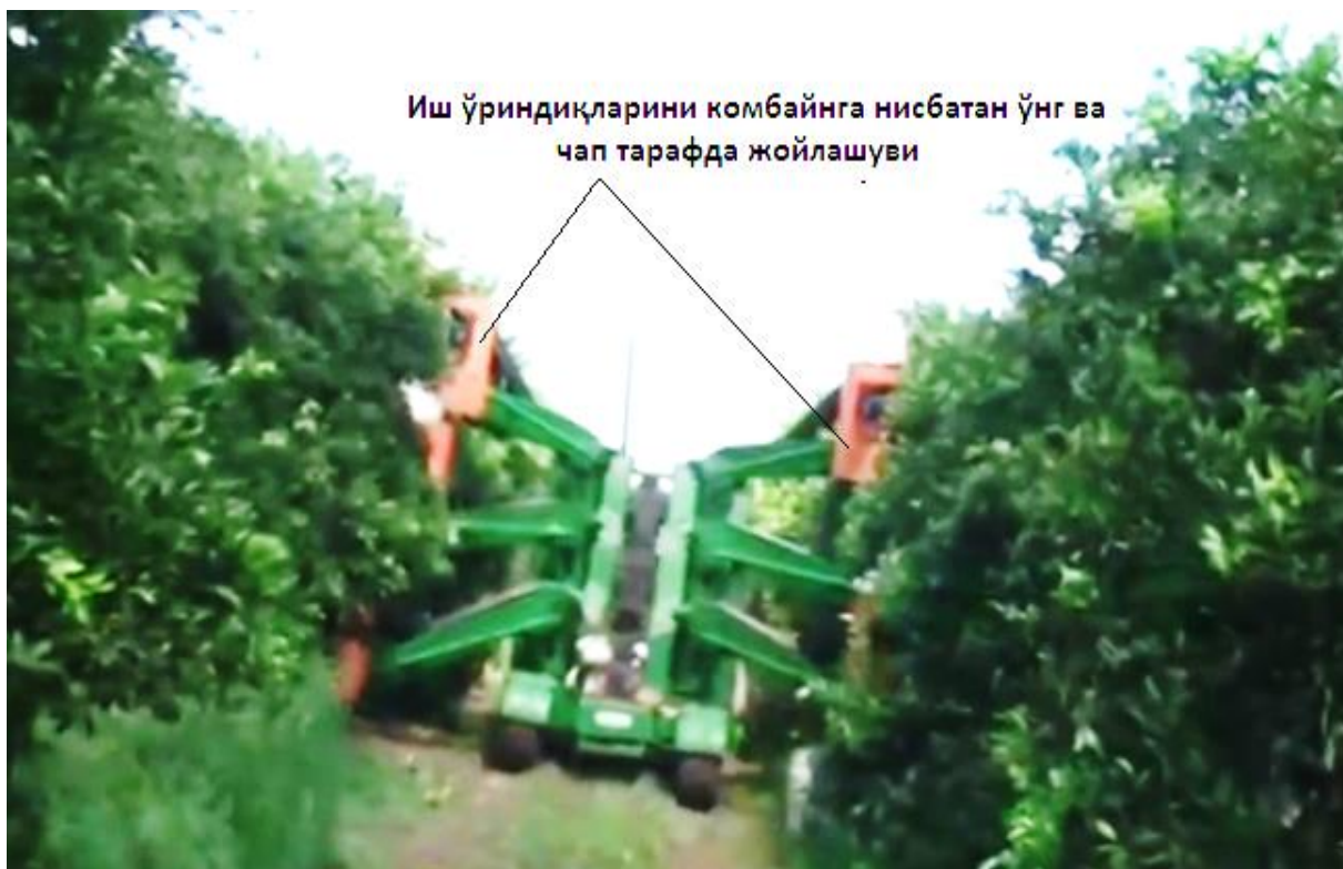
1.35-rasm. Kombaynga nisbatan ishchi qismlarini daraxt oralig‘ida joylashuvi.
