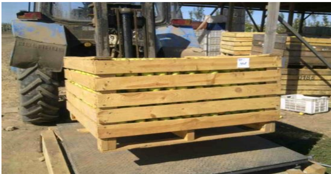
3.15-rasm. Mevalarni konteynerlarda ko‘tarish, tashish va joylashtirishda traktorning osma mexanizmidan foydalanish tartibi.
