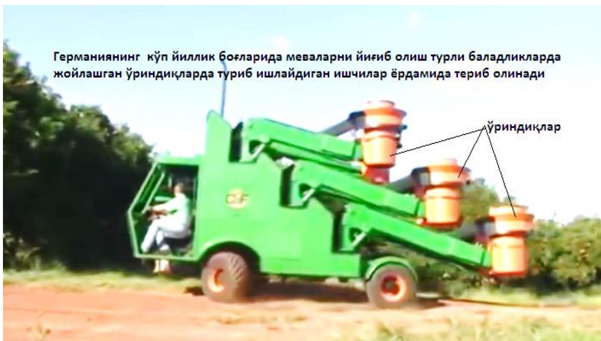
1.34-rasm. Ko‘p yillik mevalarni yig‘ib olishda Germaniyada foydalaniladigan kombayni umumiy ko‘rinishi
