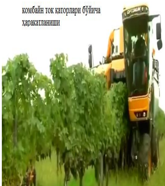
1.26 - rasm. Kombaynni tok qatorlari bo'yicha harakati va uzum boshlarini joylashuvi
