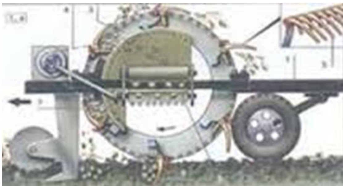
1.42-rasm. Rotorli kartoshka kavlagichning ishlash jarayoni.
