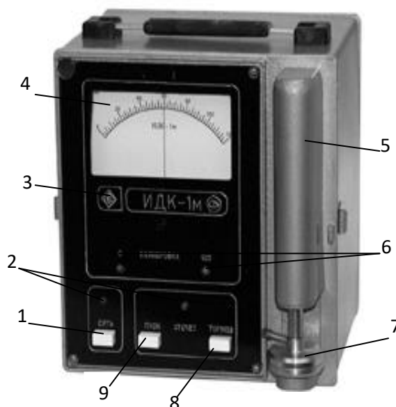
8.1–rasm. Kleykovina sifatini aniqlashga mo`ljallangan IDK-1 asbobi.
