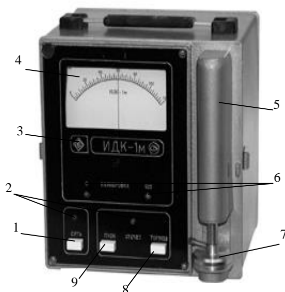
8.1-rasm. Kleykovina sifatini aniqlashga mo`ljallangan IDK-1 asbobi.
