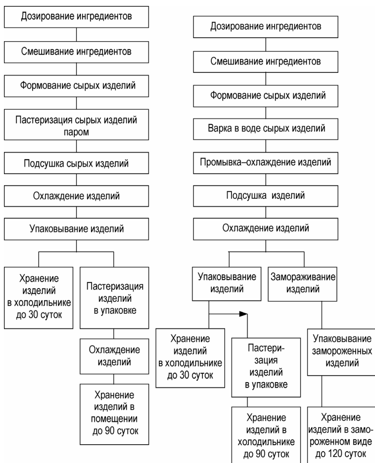
Рис. 5.2. Технологические стадии производства макаронных изделий (сырых и пропаренных)
