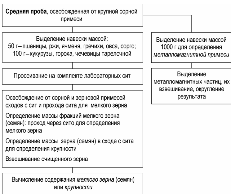
Рис. 1.6. Схема определения содержания мелких зерен (семян) и крупности и содержания металломагнитной примеси в зерне
