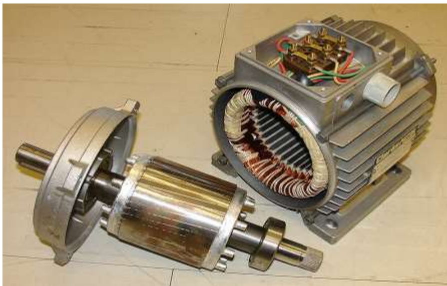
59-rasm. Uch fazali tutashtirilgan asinxron dvigatelning statori va rotorning umumiy ko'rinishi
