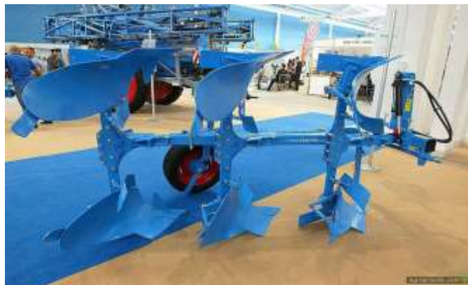
2.1-rasm. Osma to‘ntarma plugi.
