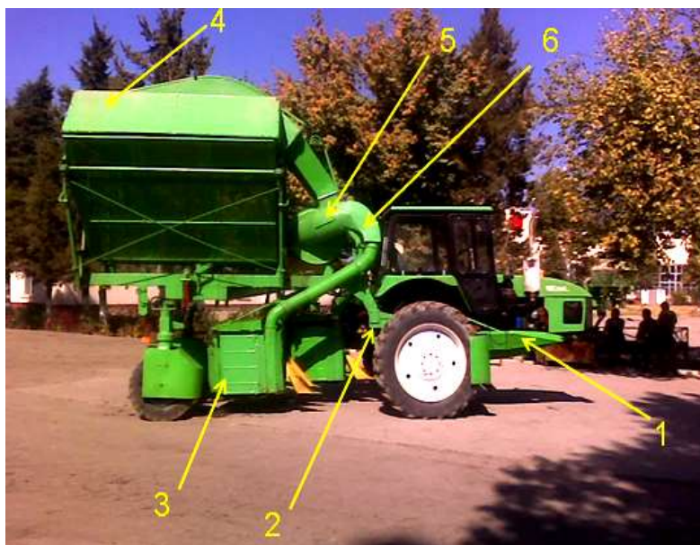
2.29- rasm. Mashinaning umumiy tuzilishi: 1- traktor; 2-rama; 3-terish apparati; 4-bunker; 5-ventilyator; 6-havo quvuri.
